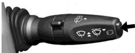
Рисунок 4.14 - Выключатель управления вспомогательным тормозом (моторный тормоз)
