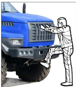
Рисунок 2.1 - Прием использования подножки и ребер облицовки радиатора при подъеме на буфер и спуска с него
