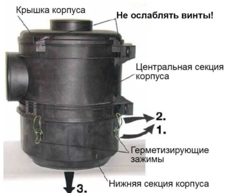
Рисунок 5.1.5 - Снятие нижней секции корпуса
